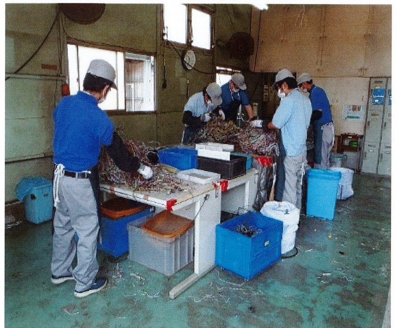
電線リサイクル作業
