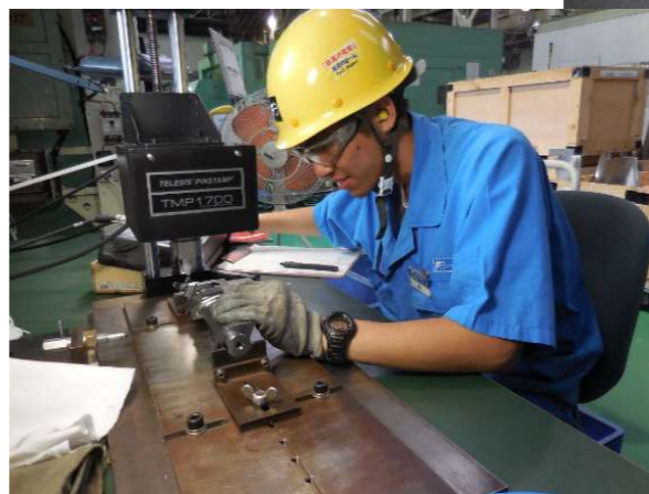
ブレード刻印作業
